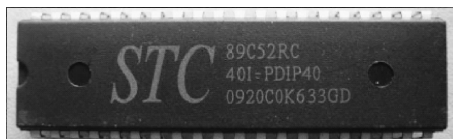
图 1-2 40 引脚双列直插式单片机实物图
