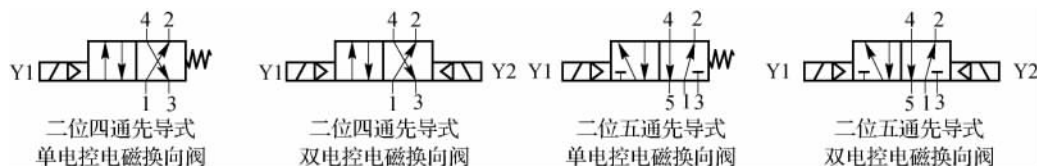
图 2-24 二位四通、二位五通先导式电磁换向阀职能符号
