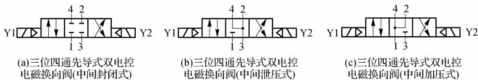
图 2-26 三位四通先导式电磁换向阀
