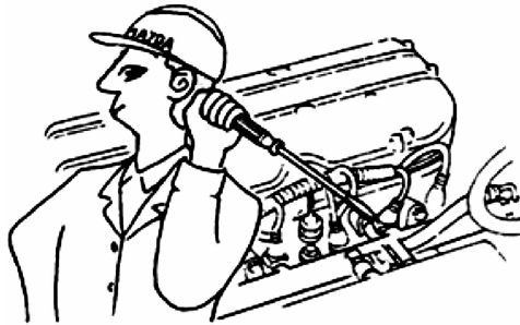
图 4-27 喷油器就车诊断
