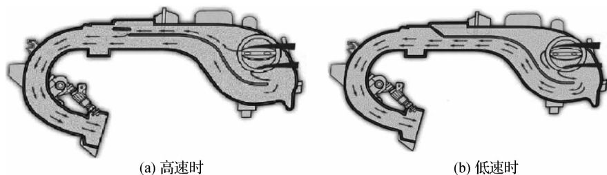
图 1-2 可变进气管截面系统结构示意图
