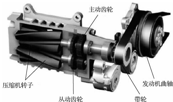
图 1-34 机械增压系统的工作原理
