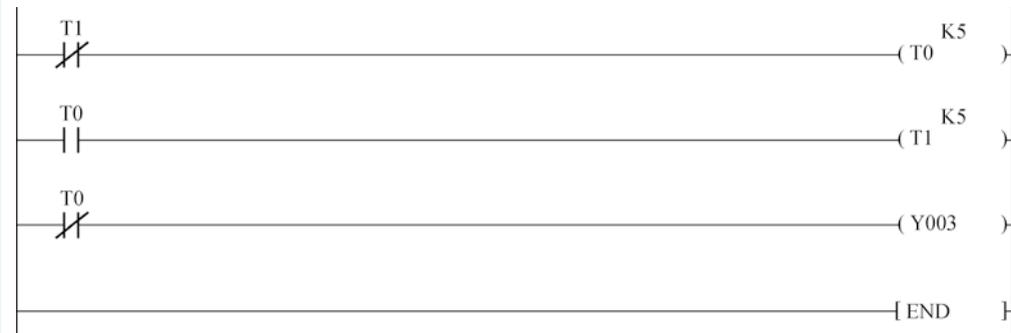
图 2-13 用定时器编制 1 Hz 闪烁程序
