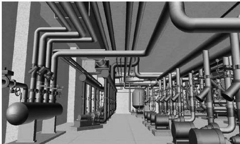
图 2-2 世博场馆的管线综合布置 BIM 应用
