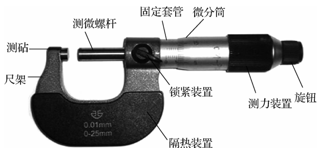
图 1-14 外径千分尺的结构
