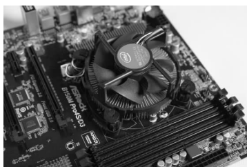
图 1-10 完成 CPU 和散热风扇的安装
