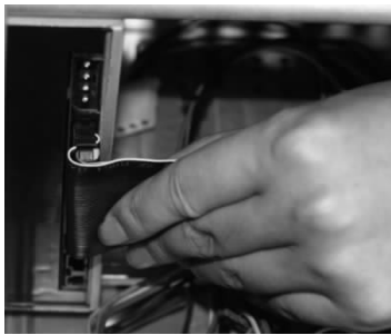
图 1-29 插入光驱数据线
