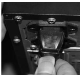
图 1-38 连接机箱电源线
