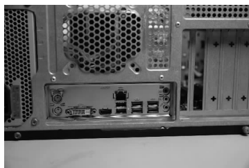
图 1-17 将主板 I/O 端口与挡板对应好
