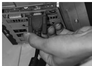
图 1-37 连接 VGA 接口
