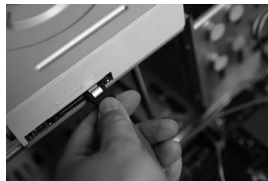
图 1-32 连接硬盘 SATA 接口的电源线
