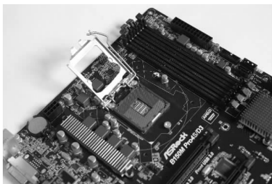
图 1-5 打开 CPU 拉杆
