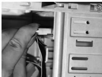
图 1-31 连接光驱电源线
