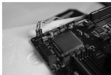
图 1-16 插入 USB 电源线
