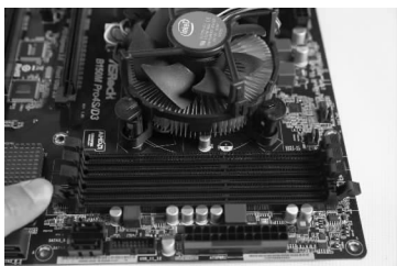
图 1-11 扳开两端的黑色卡扣
