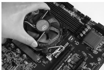
图 1-8 放上 CPU 散热风扇
