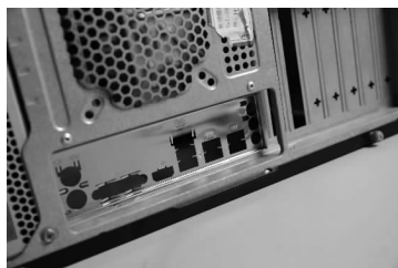
图 1-13 观察 I/O 端口位置与接口挡板
