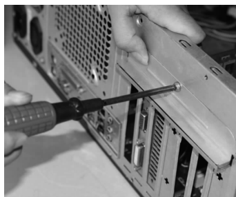
图 1-22 固定显卡挡板
