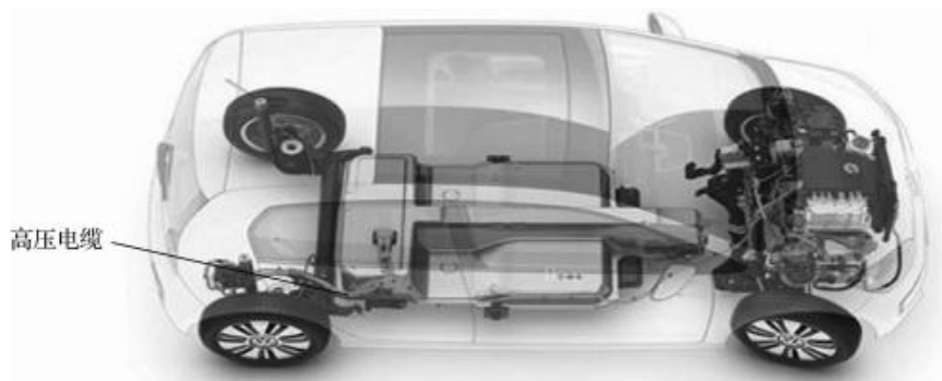
图 1-16 电动汽车中的高压电缆防护
