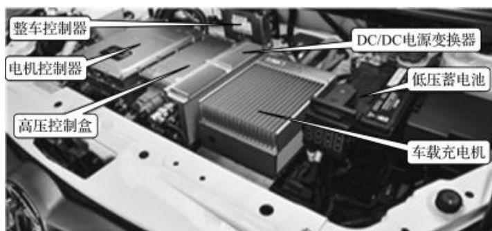
图 1-21 前机舱内的高压部件和低压部件
