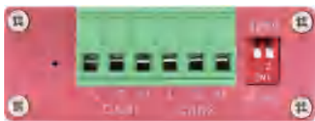
图 1-23 CAN 总线分析仪终端电阻设置
