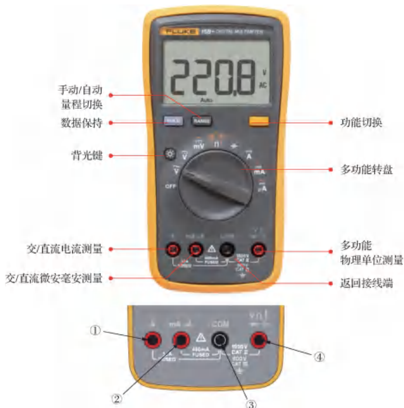
图 1-12 数字万用表接线端示意图
