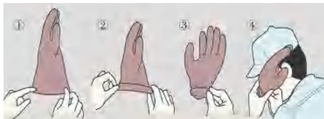
图 1-4 绝缘手套检查方法
